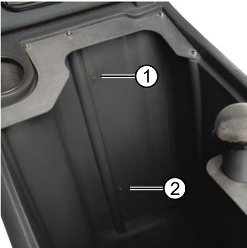
1. Schmutzwassersensor **(1)** reinigen.
