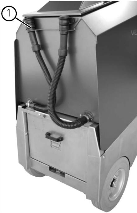
1. Den Frischwasserschlauch (1) aus der Halterung nehmen.
